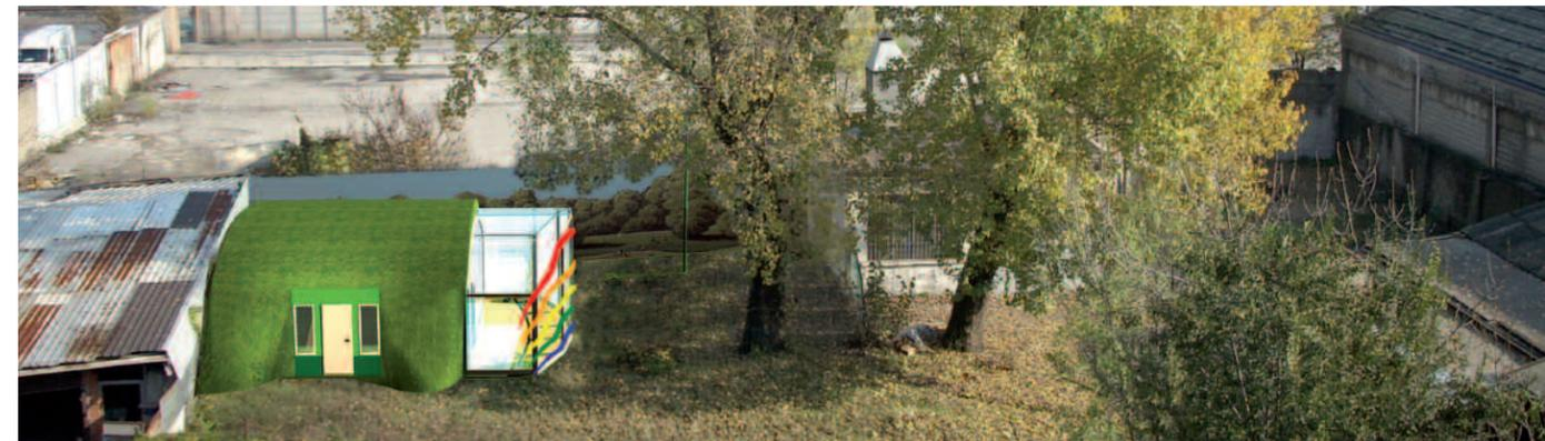
prospetto sud delle lame metalliche multiformi e multicromatiche - su cui vengono posizionati i pannelli solari - che hanno la doppia funzione di schermare dai raggi solari e produrre energia elettrica. La forma, così concepita, è coperta di prato fino a terra e si armonizza con il terreno circostante, anch'esso seminato a prato, così da valorizzare il lotto nel contesto esterno.
